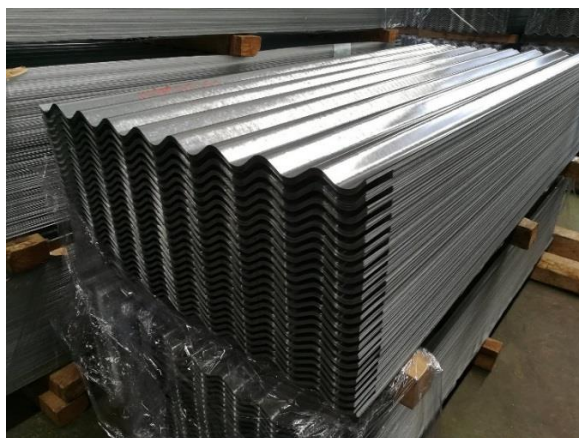
รูปที่ 3.23 แผ่นสังกะสีลูกฟูกสำหรับใช้งานรั้ว และหลังคา
