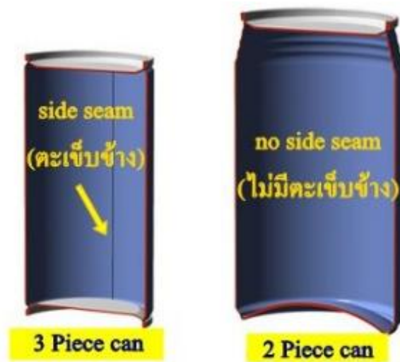
รูปที่ 5.57 ตัวอย่างบรรจุภัณฑ์จากโลหะแบบ 2 ชิ้น และ 3 ชิ้น ที่มา : https://sites.google.com/site/kailove100/krapxng
