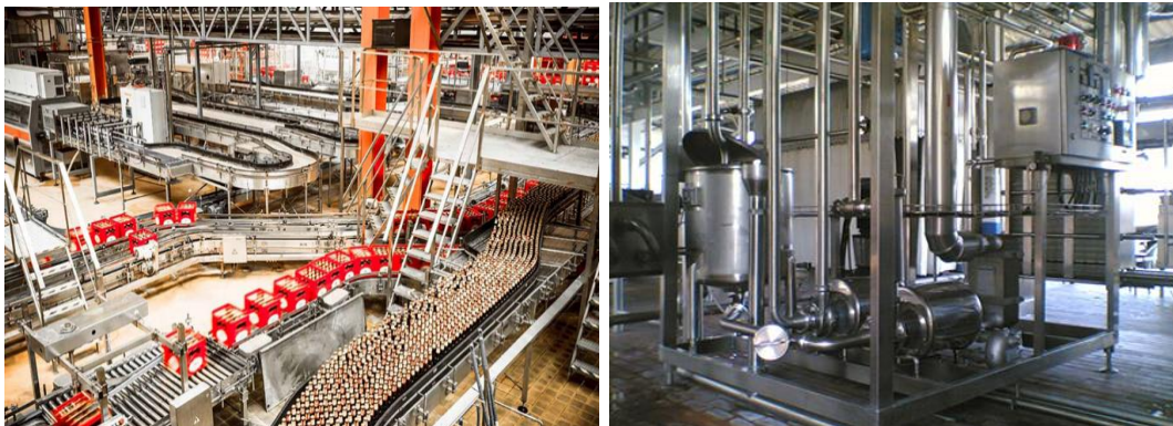
รูปที่ 5.44 ตัวอย่างเหล็กแผ่นรีดเย็นชนิดเหล็กกล้าไร้สนิมในเครื่องจักรกลของอุตสาหกรรมอาหาร
